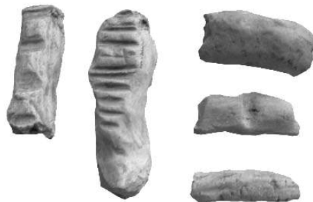
Fig. 18 Elementos de horno: separadores y testigos termométricos
