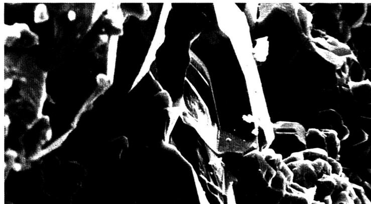
Fig. 8. Microfotografía de la piedra caliza de Hontoria, realizada en el microscopio electrónico de barrido, ampliada 1500 veces
