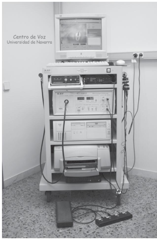
te el pedal o el mando de regulación manual se puede seleccionar el modo de actuación para observar el movimiento en cámara lenta o fijar la imagen estática dependiendo del desfase en uno o dos ciclos por debajo de la frecuencia fundamental de la fonación o de la sincronización de la frecuencia del flash y la de la fonación respectivamente.
